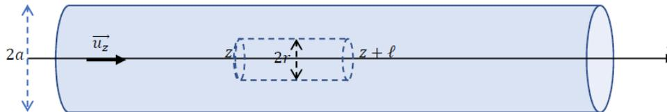
Dans la suite, on néglige l'effet du poids dans la canalisation horizontale d'axe  $z$ . Le mouvement de ce volume  $V$  est assuré par des forces pressantes. On supposera que le champ des pressions  $p$  dans la canalisation est fonction uniquement de  $z$ , on a donc  $p(z)$ .
