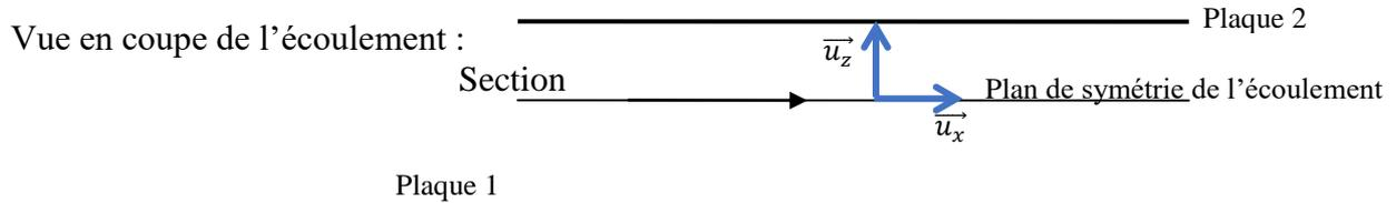
Entre les 2 plaques, la vitesse  $\vec{v}$  du fluide dépend de la distance  $z$  au plan de symétrie de l'écoulement :  $\vec{v} = v_o \cdot \left(1 - \left(\frac{z}{e}\right)^2\right) \cdot \vec{u}_x$
