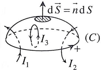
Ou encore : le flux du champ magnétostatique à travers toute section d'un même tube de champ est constant : on parle de **flux conservatif**.
