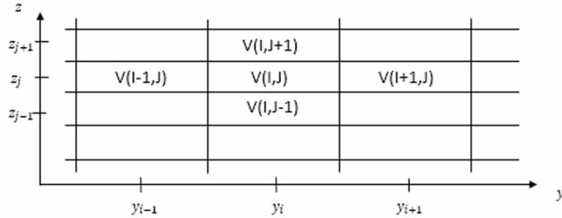
Pour résoudre l'équation de Laplace, nous allons appliquer la méthode d'Euler. A titre d'exemple, cette méthode consiste à associer la dérivée partielle  $\frac{\partial V(y,z)}{\partial y}$  à la quantité  $V(i+1,j)-V(i,j)$ .
