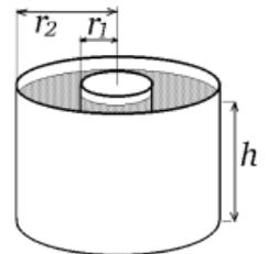
On admettra que  $\vec{j} = j_r(r) \vec{e}_r$  (système de coordonnées cylindriques) dans l'électrolyte.
