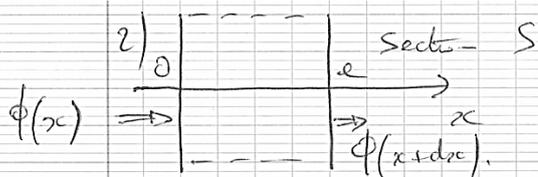
Bilan thermique :  $[j(x) - j(x+dx)] S dt = dm \cdot c [T(t+dt) - T(t)]$
