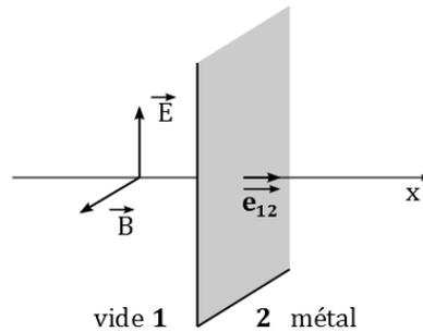
OPPM incidente, propagation suivant l'axe  $x$ , dans le sens des  $x$  croissants :  $\vec{k}_i = \vec{k}$
