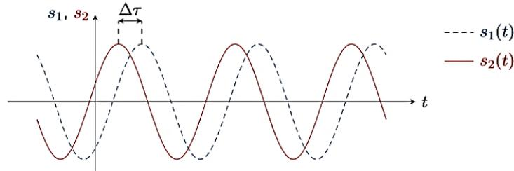
Le déphasage peut être mesuré à partir du décalage temporel  $\Delta\tau$  entre les deux signaux. En effet, en notant  $f$  la fréquence des signaux, on peut montrer que (cf. chapitre O1 paragraphe II.3.c)
