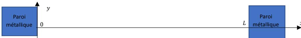
Le magnétron présent dans le micro-ondes va générer un champ électromagnétique de fréquence  $f \approx 2,5 \text{ GHz}$  (cette fréquence a été choisie pour avoir un bon compromis entre la pénétration du champ dans les aliments et sa dissipation sous forme thermique par interaction avec les molécules d'eau). Pour ce modèle simple, le champ électrique qui s'établit dans la cavité est tel que  $\vec{E} = E(x, t)\vec{u}_y$ . On montre que ce champ électrique vérifie :
