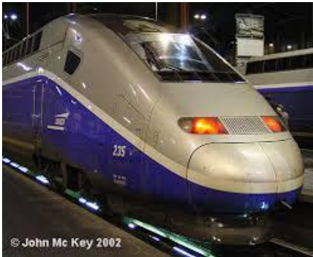
TGV Duplex – 8 moteurs asynchrones 1,1MW
