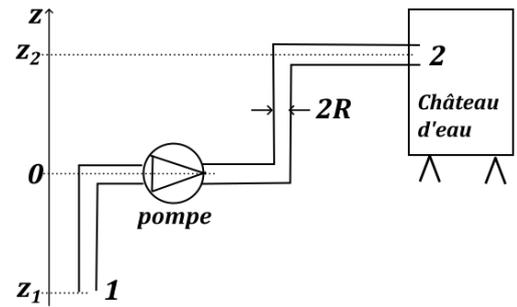
$z_2 = 10 \text{ m}, z_1 = -10 \text{ m}$ , conduite de rayon  $R = 100 \text{ mm}$
