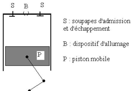
S : soupapes d'admission et d'échappement
