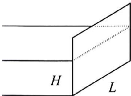
Un barrage est constitué d'une paroi verticale de largeur  $L$ . De l'eau, assimilée à un fluide incompressible de masse volumique  $\rho_0$ , appuie sur une hauteur  $H$  sur une des faces du barrage. La pression atmosphérique  $P_0$  s'exerce sur l'autre face du barrage et sur la surface libre de l'eau. L'axe vertical ( $Oz$ ) est vertical ascendant et le champ de pesanteur  $g$  est uniforme.
