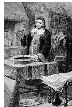
La pression atmosphérique s'exerçant sur la surface du liquide dans la bassine fait monter le liquide dans le tube (ou l'empêche de se vider). Si le tube est suffisamment grand, du vide est obtenu au-dessus de la colonne de liquide dans le tube (en fait, il s'y trouve en quantité faible de la vapeur de liquide à sa pression de vapeur saturante).
