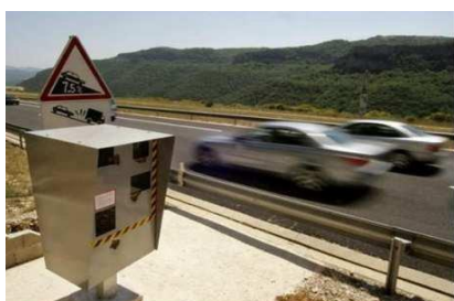
Radar automobile = approche eulérienne de la circulation automobile = mesure de la vitesse des véhicules, en un point donnée, à un instant donné.
