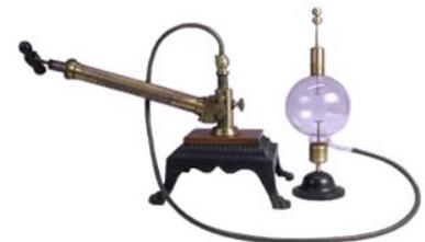
Le principe de ces tubes est de mettre dans l'ampoule des gaz (comme du dihydrogène) sous faible pression (la pompe permet de réaliser le vide). On provoque à l'intérieur de l'ampoule de fortes décharges électriques, les atomes d'hydrogènes sont alors excités. En se désexcitant, ils émettent une lumière dont le spectre est discontinu.
