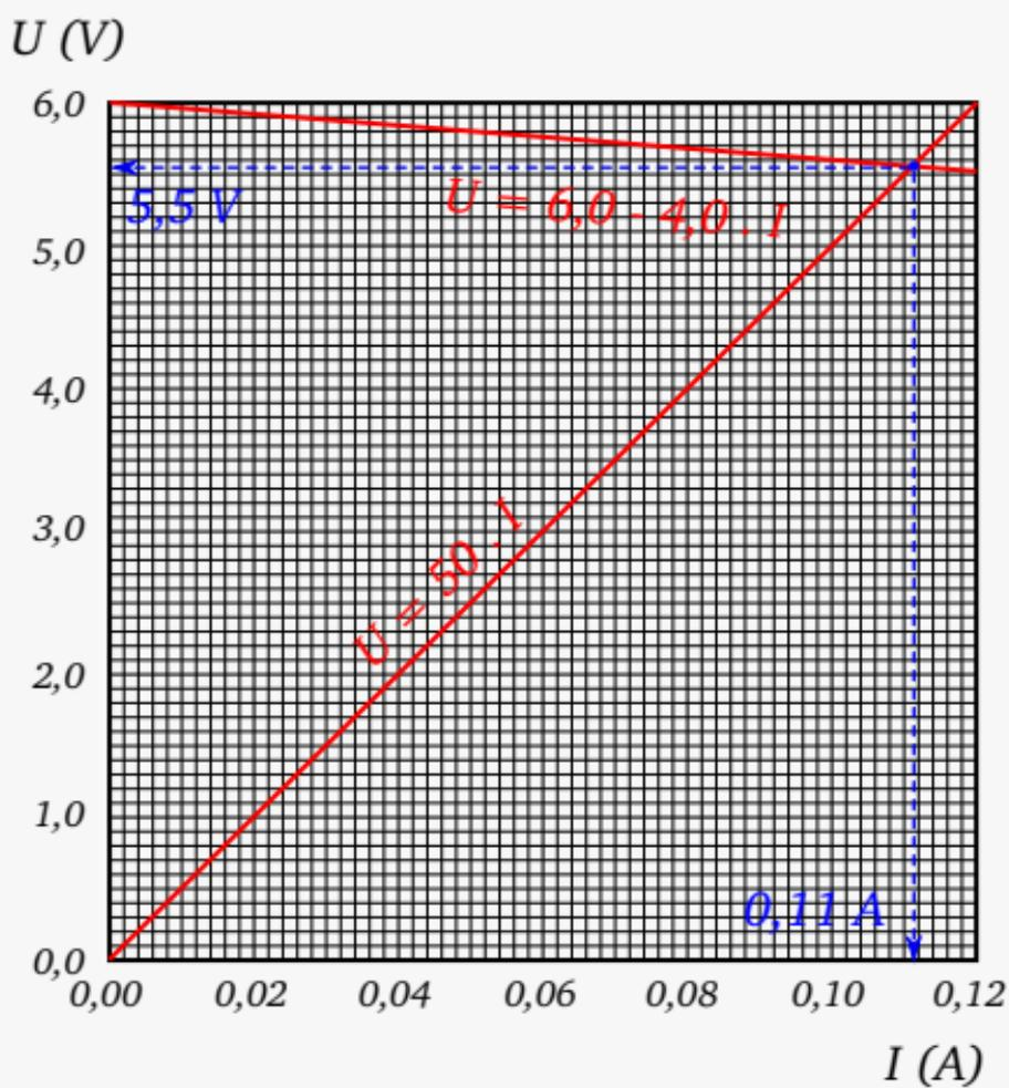
Figure 8 – Point de fonctionnement.
