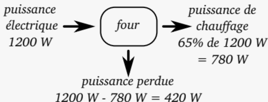
Figure 9 – Bilan de puissance du four
