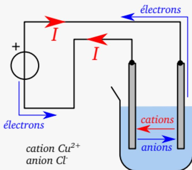
Figure 1 – L'électrolyseur.
