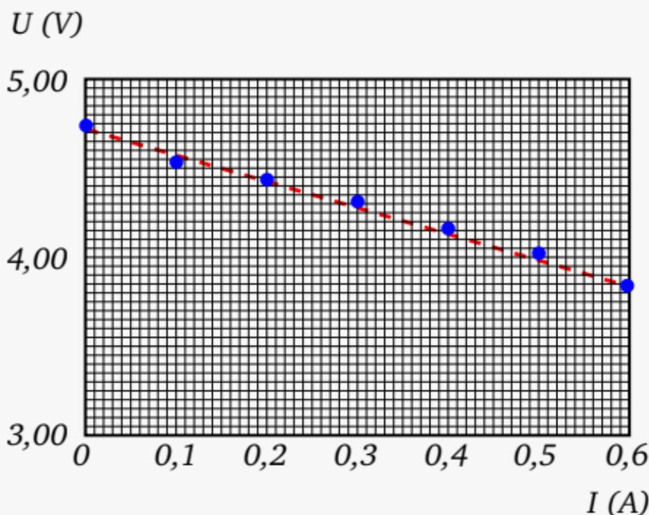
Figure 6 – Mesure de la caractéristique tension courant d'une pile.
