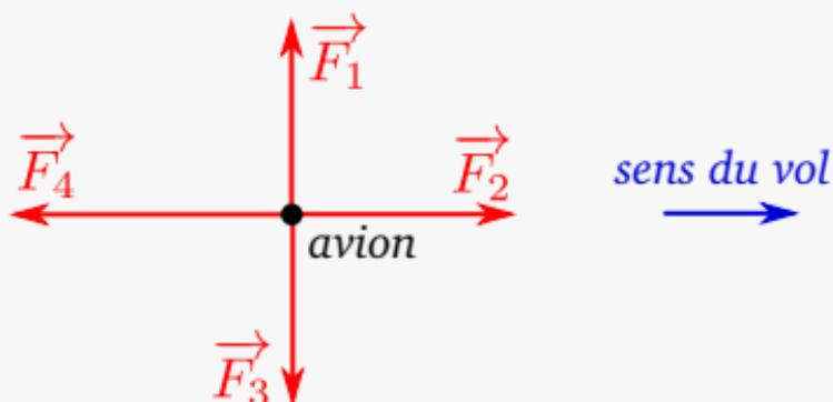
Figure 4 – Forces agissant sur l'avion en vol
