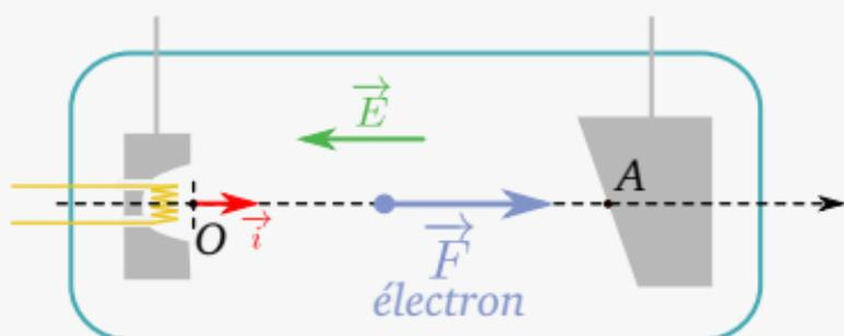
Figure 11 – Électron dans un tube à rayon X
