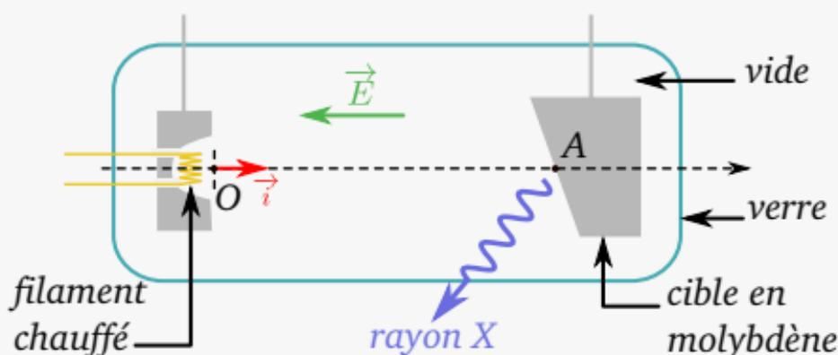
Figure 10 – Principe du tube à rayon X
