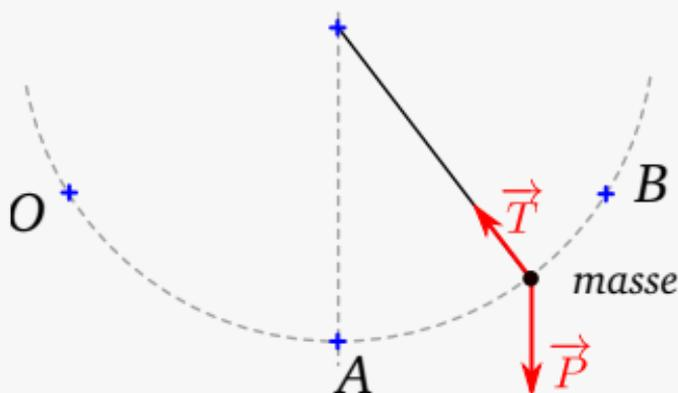
Figure 9 – Principe du pendule pesant
