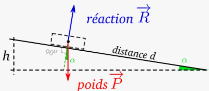
Figure 14 – Bilan des forces sur le traîneau
