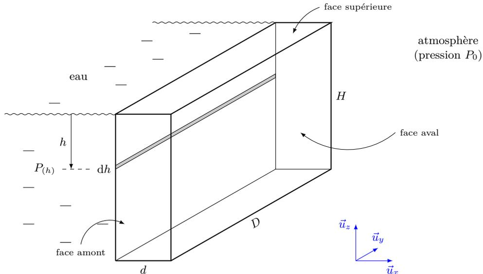
1. Exprimer la force pressante  $\vec{F}_1$  exercée par l'air sur la face aval, en fonction de  $P_0$  et des dimensions du barrage.
