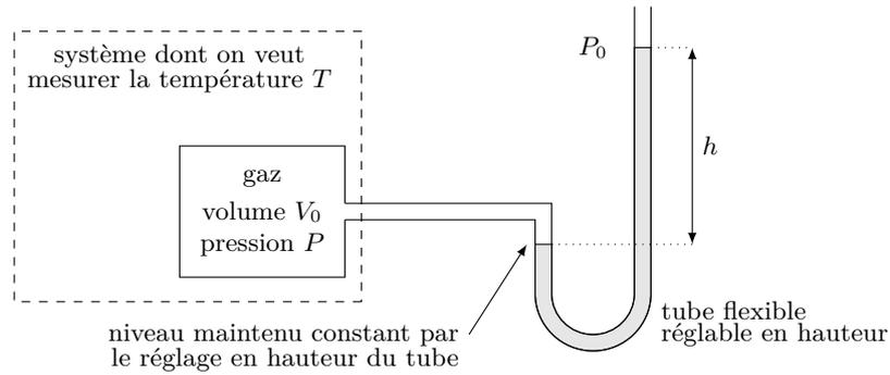
Dans un premier temps, on plonge le réservoir dans un mélange eau-glace, et on attend l'équilibre du gaz. Après réglage de la hauteur du tube, la dénivellation du liquide est  $h_1$  et la température du gaz est  $T_1$ . On place ensuite le réservoir dans un liquide dont on veut mesurer la température  $T_2$ . On attend l'équilibre thermique, et on règle la hauteur du tube. La dénivellation est alors  $h_2$ .
