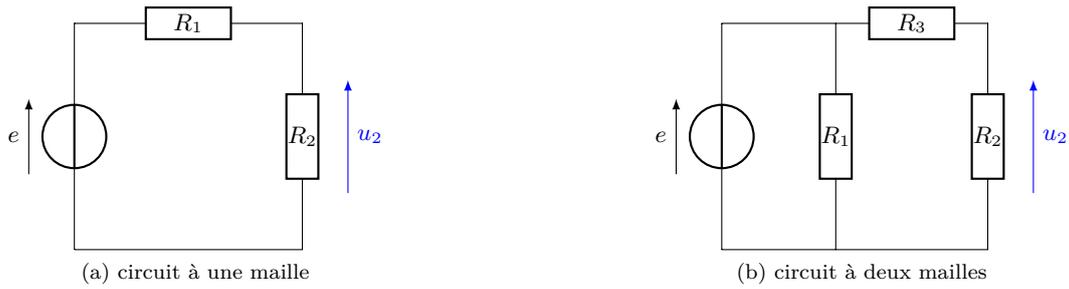
FIGURE 29 – Utilisation du diviseur de tension.
