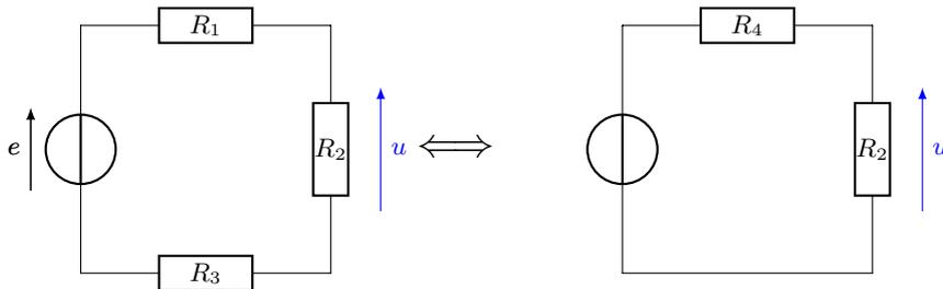
Dans ce circuit, les résistances  $R_1$  et  $R_3$  sont en série et peuvent être associées en une résistance équivalente  $R_4 = R_1 + R_3$ . Les résistances  $R_4$  et  $R_2$  étant en série et soumises à la tension totale  $e$ , on peut appliquer le diviseur de tension :
