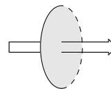
Dans un conducteur électrique (un fil), la surface de contrôle pertinente est la **section du fil**, autrement dit la surface obtenue en coupant le fil perpendiculairement à son axe.
