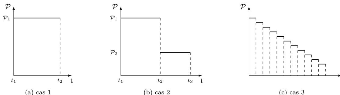
FIGURE 33 – Détermination de l'énergie pour des puissances constantes par morceaux.
