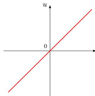
FIGURE 13 – Caractéristique d'un résistor.
