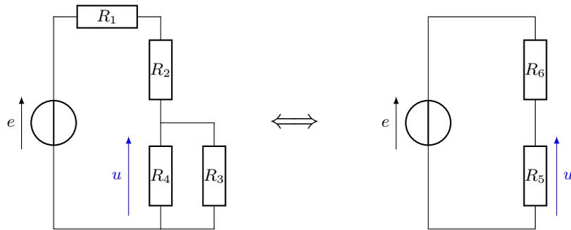
FIGURE 30 – Utilisation des lois d'association et du diviseur de tension.
