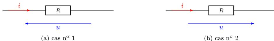
FIGURE 12 – Application de la loi d'Ohm.
