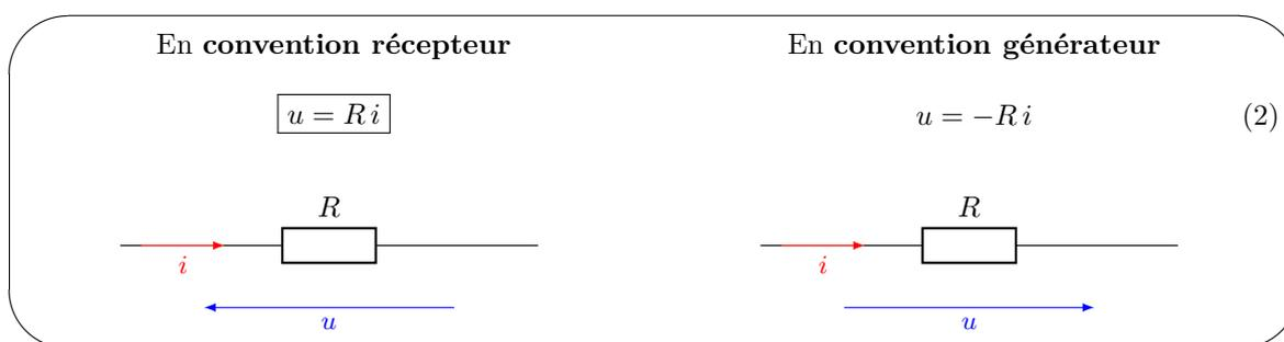
Par abus de langage, on confond fréquemment l'objet *résistor* avec sa caractéristique électrique. On parle donc fréquemment de **résistance** pour qualifier un résistor ou tout composant équivalent à un résistor dans un circuit.
