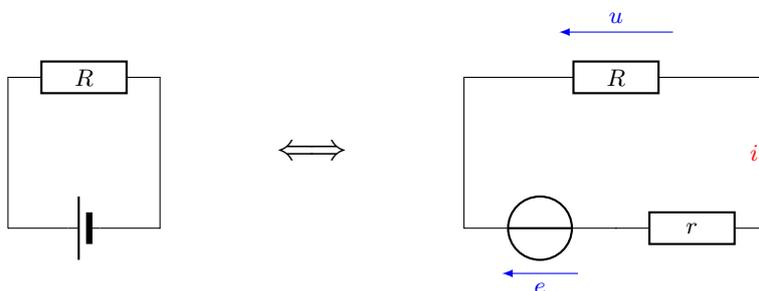
Il faut, comme toujours, commencer par récrire le circuit avec la représentation de Thévenin du générateur. On identifie alors facilement un pont diviseur de tension, qui permet d'obtenir :
