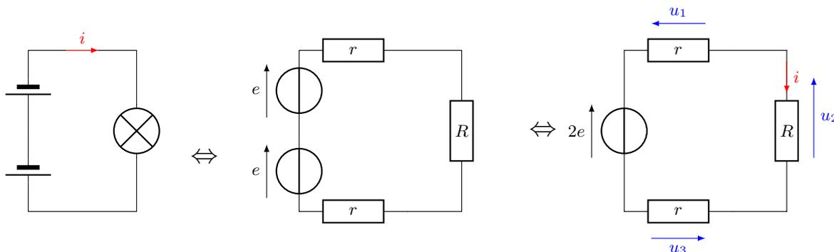
FIGURE 23 – Circuit à deux générateurs et ses représentations équivalentes.
