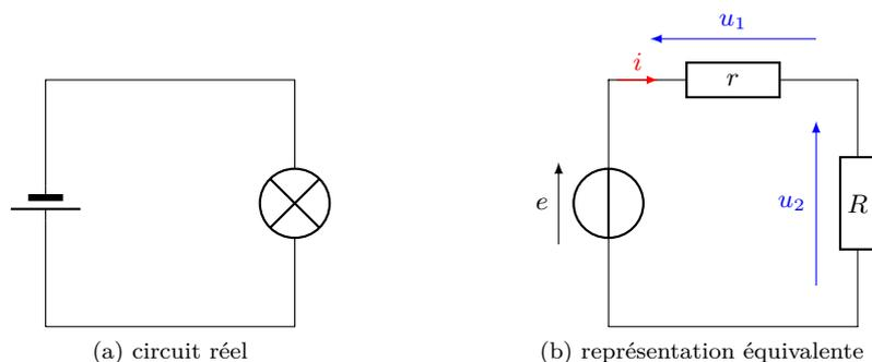
FIGURE 22 – Circuit avec une lampe alimentée par une pile.
