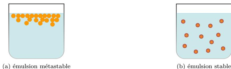
FIGURE 19 – Émulsion métastable et stabilisée par émulsifiant.
