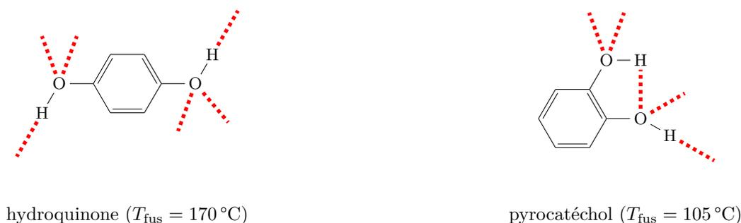
FIGURE 12 – Liaisons hydrogène dans deux dihydroxybenzène.
