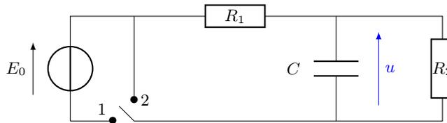
2. On bascule maintenant l'interrupteur en position 2. Déterminer la constante de temps du circuit, et la valeur de  $u$  lorsque le régime permanent est atteint.
