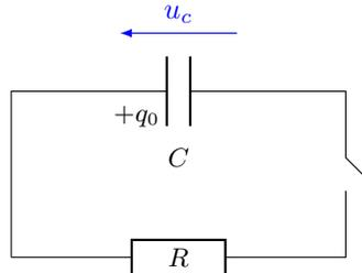
1. Déterminer l'évolution de la charge du condensateur en fonction du temps. Quelle est la constante de temps du circuit? Tracer  $q(t)$ .
