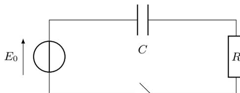
1. Établir l'équation différentielle vérifiée par la tension  $u_c$  aux bornes du condensateur. Donner l'expression de la constante de temps  $\tau$  du circuit.
