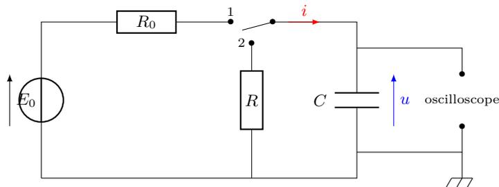
Après un temps très long avec l'interrupteur en position 1, la tension aux bornes du condensateur est  $E_0$ . Le basculement de l'interrupteur en position 2 réduit le circuit à un condensateur en série avec la résistance  $R$ . L'équation différentielle vérifiée par  $u$  s'obtient en écrivant successivement la relation entre l'intensité et la tension  $u$  aux bornes du condensateur et de la résistance :
