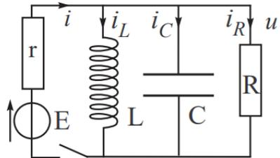
Sur ce schéma, les grandeurs  $E$ ,  $r$ ,  $L$ ,  $C$  et  $R$  sont des constantes réelles strictement positives exprimées en u.s.i. Ses connaissances en électricité le conduisent à démontrer que :
