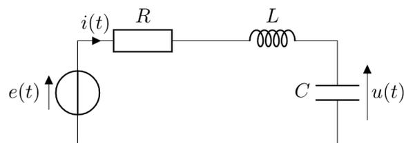
FIGURE 26.2 – Un circuit RLC monté en série
