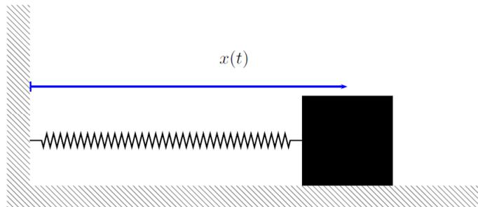
FIGURE 26.1 – La force de rappel s'exerçant sur un ressort
