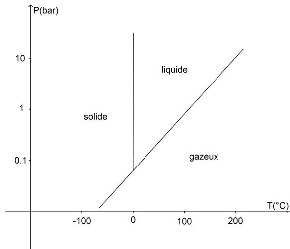
Sur ce diagramme, où l'axe de la pression est en échelle logarithmique, la courbe de fusion (passage de l'état solide à l'état liquide) est modélisée par la droite d'équation  $T = 0$ , et les courbes de vaporisation et de sublimation (passage de l'état liquide ou solide à l'état gazeux) sont modélisées par la droite d'équation  $\log_{10}(P) = \frac{1}{50}T - 2$ .
