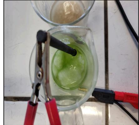
*Montage de la pile microbienne, on peut voir la cathode contenant le coton et la chlorelle et l'anode contenant la levure et le sucre. Les deux sont reliés par l'intermédiaire d'électrodes et de fils électriques. Le pont salin ferme le circuit.*
