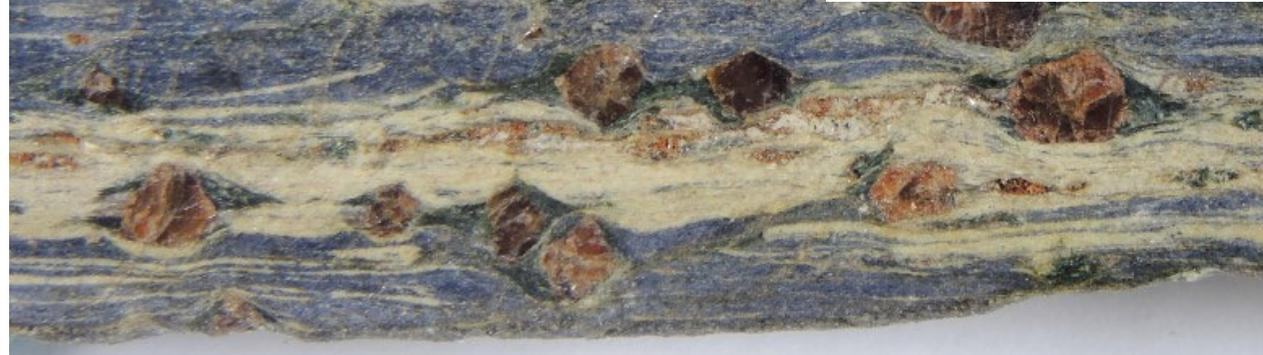
Si il y a de gros minéraux dans la roche avant sa déformation, la schistosité est déviée par eux, et il y a des zones de plus faible pression autour de ces minéraux où il y aura des recrystallisation. **L'ensemble forme une ombre de pression.**
