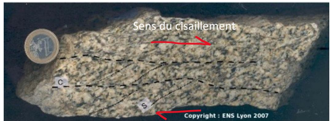
Les plans C et S indiquent un cisaillement "dextre"
