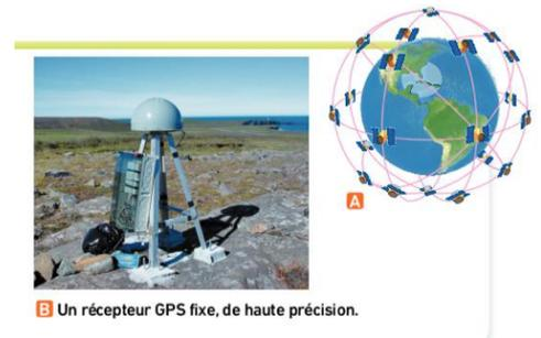
B Un récepteur GPS fixe, de haute précision.
