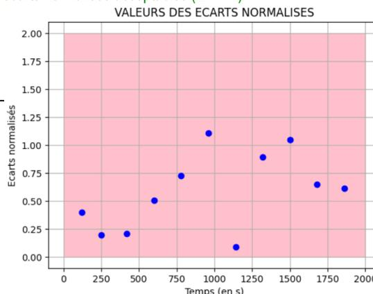
10- On obtient le graphique représenté ci-contre sur lequel on constate que **chaque point expérimental est caractérisé par un écart normalisé inférieur à 2.**
