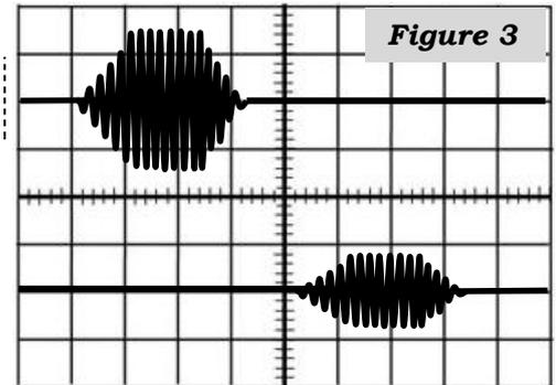
» Disposer les Récepteurs pour être dans la situation de la **Figure 3** ; on prendra pour cela une distance entre les récepteurs au moins égale à 10 cm.
