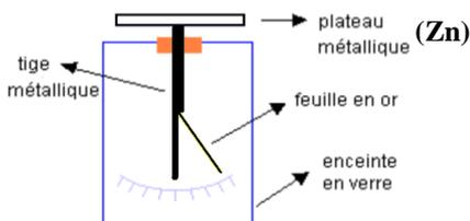
➔ Étape ① : une plaque de zinc est fixée sur le plateau de l'électroscope puis mise en contact avec un bâton d'ébonite préalablement chargé négativement par frottement. On retire alors le bâton d'ébonite.
