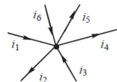
☞ - **Application 9** : Quelle relation existe-t-il entre  $i_1$ ,  $i_2$ ,  $i_3$ ,  $i_4$ ,  $i_5$  et  $i_6$  pour le nœud représenté ci-contre ?
