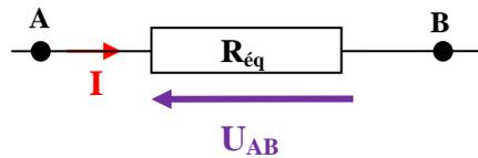
☞ - **Application 18** : En appliquant la loi d'Ohm aux différents dipôles, trouver l'expression de  $R_{eq}$  en fonction de  $R_1$  et  $R_2$ .
