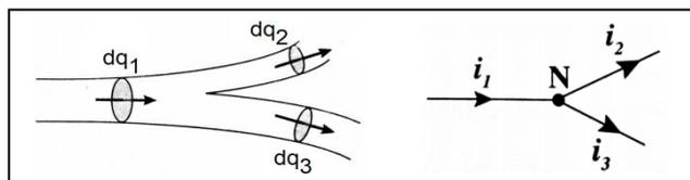
☞ - **Application 8** : Sur le schéma ci-contre, quelle relation existe-t-il entre  $dq_1$ ,  $dq_2$  et  $dq_3$  ? Entre  $i_1$ ,  $i_2$  et  $i_3$  ?
