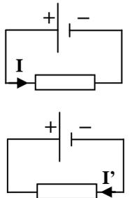
• **Mesure de l'intensité du courant électrique** : on la mesure avec un **ampèremètre placé en série** dans la branche étudiée. L'ampèremètre est symbolisé dans les circuits électriques par un A entouré et il **mesure l'intensité du courant électrique qui rentre par la borne A/mA**.
