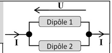
On cherche à remplacer l'association PARALLELE des deux conducteurs ohmiques de résistances  $R_1$  et  $R_2$  par un seul conducteur ohmique de résistance  $R_{eq}$ .
