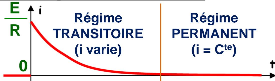
• On note que  $\lim_{t \rightarrow +\infty} (i) = 0$  ➔ En régime permanent, le condensateur est équivalent à un **interrupteur ouvert**
