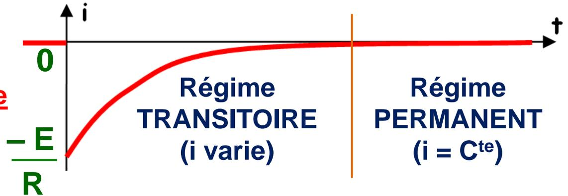
➡ En régime permanent, le condensateur est équivalent à un **interrupteur ouvert**
