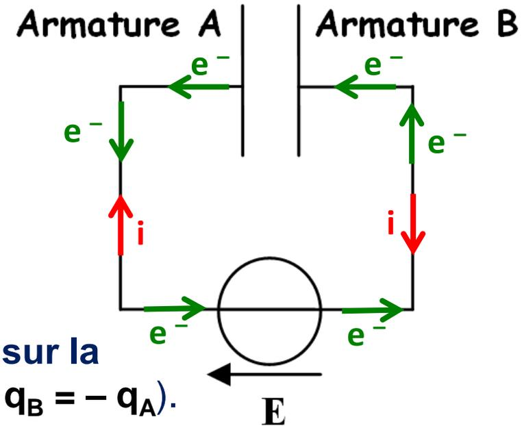
🔑 La CAPACITE d'un condensateur : De quelques **pF** ( $10^{-12}$  F) à **mF** ( $10^{-3}$  F)
