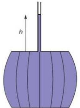
Il versa ensuite de l'eau dans le tube et constata que pour une hauteur « h » d'eau dans le tube, les forces pressantes qui s'exercent sur les parois du tonneau le font commencer à fuir jusqu'à explosion du tonneau !
