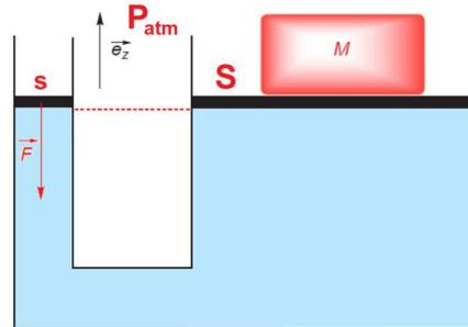
On pose sur le grand plateau un objet de masse  $M$ . Pour que les deux plateaux restent à la même hauteur, on est obligé d'exercer sur le petit plateau une force pressante  $\vec{F}$  verticale.
