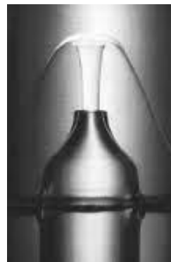
Effet thermomécanique dans l'hélium superfluide : fontaine d'hélium créée par l'échauffement de l'hélium superfluide
