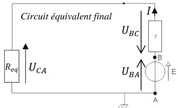
3- Dans le circuit équivalent final, les deux conducteurs ohmiques de résistances  $R_{\text{eq}}$  et  $r$  sont associés en série, on reconnaît un pont diviseur de tension, et on peut appliquer la formule pour trouver la tension aux bornes de la résistance équivalente, notée  $U_{CA}$ .
