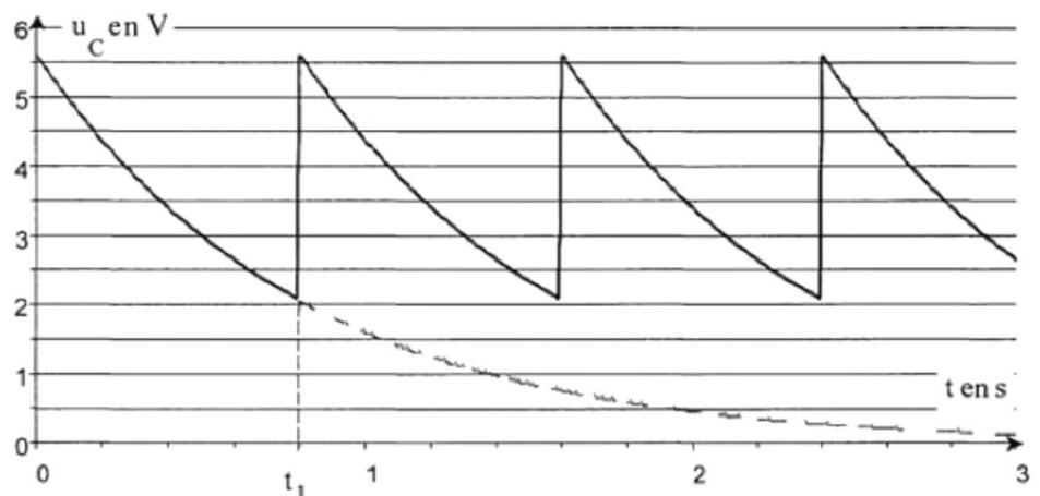
**Figure 2** : tension électrique aux bornes du condensateur
