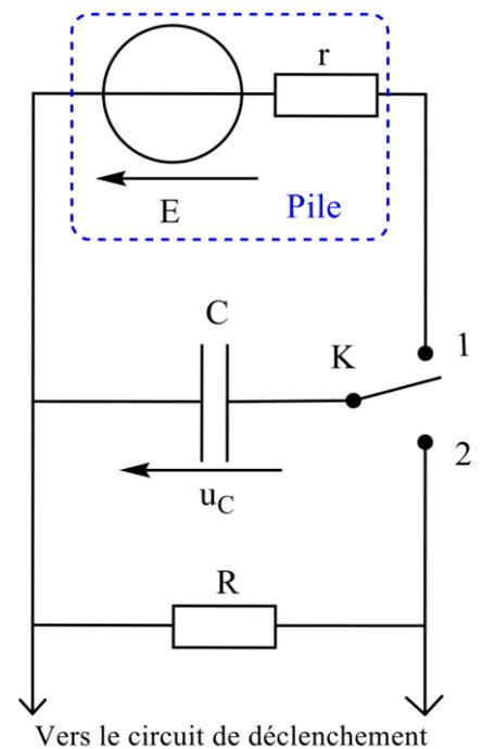
**Figure 1** : circuit électrique du pacemaker
