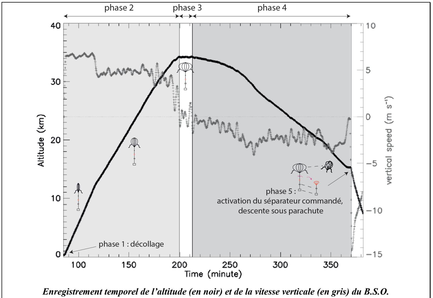
11. A l'aide de l'enregistrement réalisé lors du vol du ballon-sonde *Spirale* (voir **Document 4**), caractériser le mouvement du ballon, durant la phase 2, dans la troposphère.
