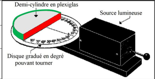
4- Le point d'incidence **est le centre du demi-cylindre** : le rayon réfracté suit donc le rayon d'un cercle et **atteint le dioptré D2 en étant perpendiculaire à celui-ci**. Ce rayon ressort alors du dioptré D2 sans être dévié.
