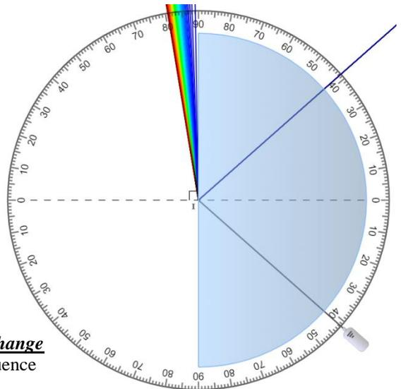
Or, dans cette formule, quel que soit le rayon réfracté,  $n_A$  et  $i_P$  ne dépendent pas de la fréquence de l'onde lumineuse. En revanche,  $i_A$  dépend de la fréquence de l'onde lumineuse : on en déduit que **l'indice de réfraction du plexiglas  $n_P$  dépend lui aussi de la fréquence de l'onde lumineuse.**
