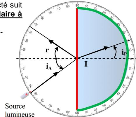
**Remarque** : Tracer le graphique  $i_A$  en fonction de  $i_P$  n'aurait en revanche pas conduit à une fonction linéaire. En effet,  $i_A = \arcsin\left(\frac{n_A}{n_P} \times \sin(i_P)\right)$ , ce qui ne traduit pas une proportionnalité entre  $i_A$  et  $i_P$ .
