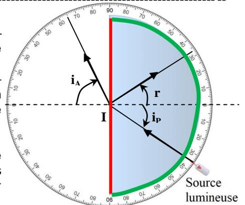
12- On observe le phénomène de réflexion totale à partir d'un angle d'incidence limite  **$i_{P,LIM} = 42^\circ$**
