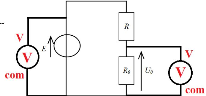
☞11- On réalise les mesures avec  $R_0 = 1,0 \text{ k}\Omega$  ; on obtient expérimentalement :  $E = 5,019 \text{ V}$  et  $U_0 = 1,707 \text{ V}$ .
