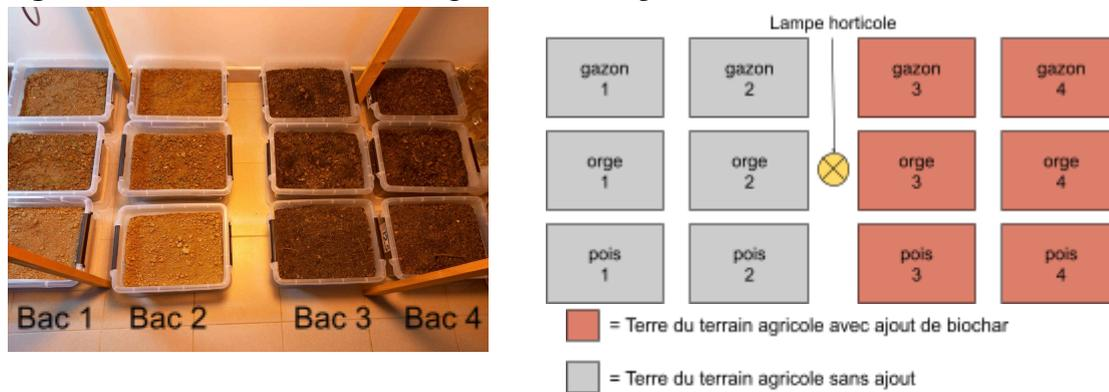
900,0 +/- 1,2g de biochar de marque *ÉlémentTerre*® ont été ajoutés dans la moitié des bacs selon la figure 6, soit 10 % du volume total, conformément aux instructions du fabricant.
