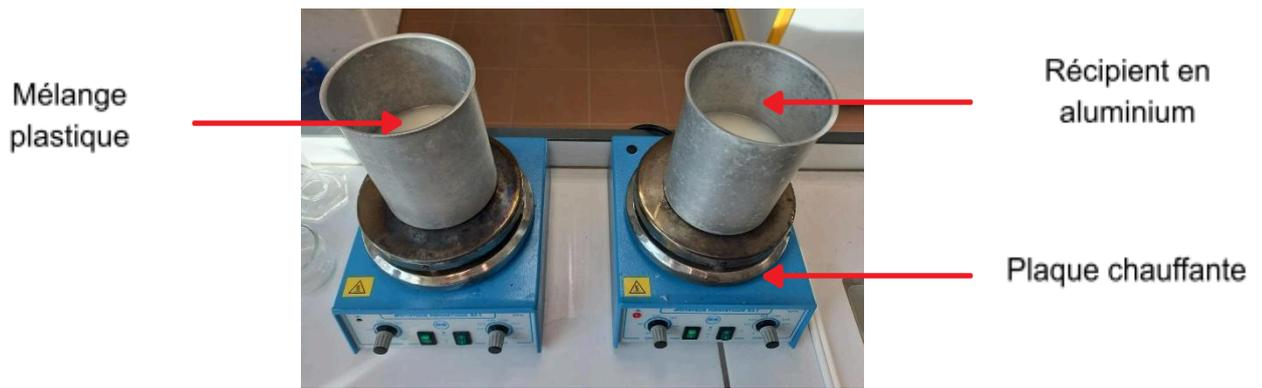
**Figure 1 : Chauffage des mélanges bioplastiques**
