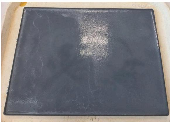
**Figure 2 : Plastique d'amidon coulé dans un moule**
