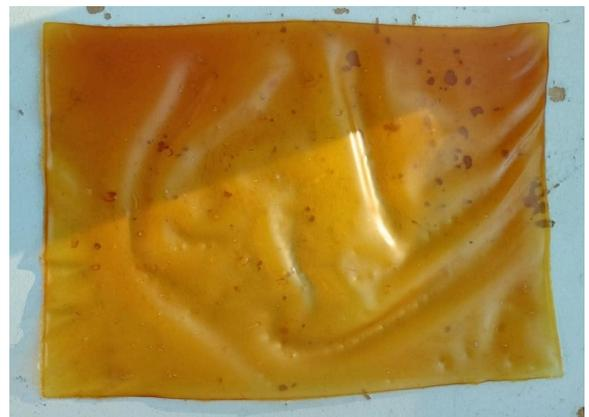
**Figure 3 : Plaque de plastique de chitosan démoulée**
