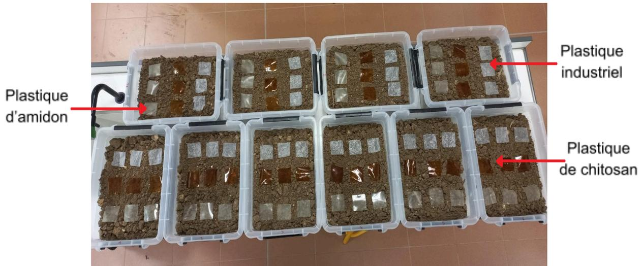
**Figure 4 : Échantillons de plastique mis en décomposition dans les différents bacs**
