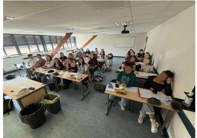
La manipulation est réalisée 6 fois, la salle de classe est aérée avant le début de la mesure de façon à atteindre une concentration initiale de CO<sub>2</sub> de  $425 \pm 5$  ppm. La moyenne des concentrations relevées à un même temps donné, ainsi que son erreur standard à la moyenne, sont calculées.
