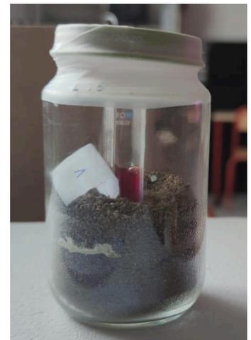
**Figure 7:** Gel en contact avec le CO<sub>2</sub> dégagé par un échantillon de terre.
