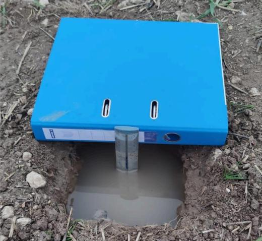
Un trou de 20 cm par 20 cm sur une profondeur de 25 cm est creusé à l'aide d'une bêche. Un tasseau est posé en travers du trou. La mesure de la hauteur est faite entre le niveau d'eau et le point de repère sur le tasseau qui est le même à chaque mesure. La fosse a été remplie d'eau jusqu'à environ 5 cm en dessous du tasseau tout en veillant à ne pas modifier la géométrie de la fosse. L'eau s'écoule pendant 1h afin de permettre une saturation du sol.
