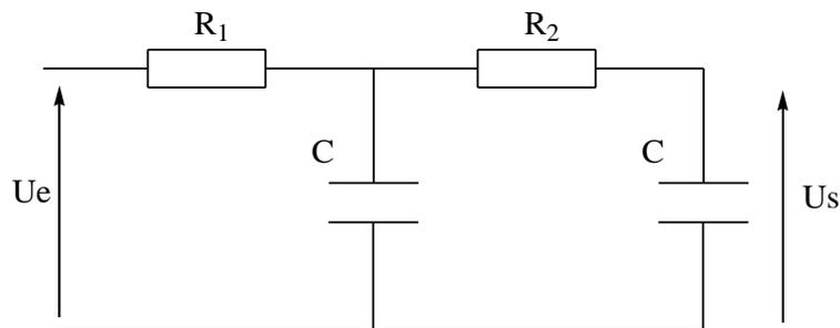
Le générateur délivre une tension constante  $U_e = E$ . Etablir l'équation différentielle vérifiée par  $U_s$  au cours du temps et la mettre sous la forme canonique en faisant intervenir la pulsation propre et le facteur de qualité.
