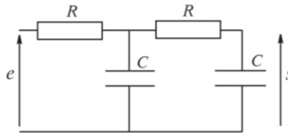
La fonction de transfert de ce filtre s'écrit :  $\underline{H} = \frac{\underline{s}}{\underline{e}} = \frac{1}{1 - R^2 C^2 \omega^2 + j3RC\omega}$
