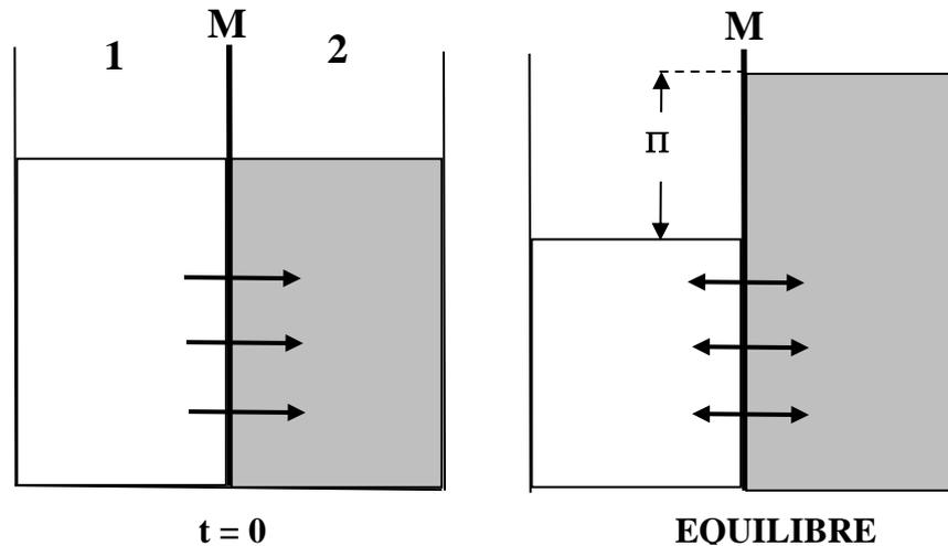
Figure 1 : Principe de l'osmose.
