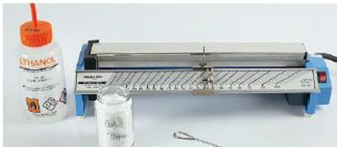
Une fois le solide séché à l'étuve on mesure son point de fusion à l'aide d'un **banc Köfeler** gradué tous les 2°C. Celui-ci doit être au préalable **étalonné** avec un produit de référence dont la température de fusion se rapproche le plus possible de celle du composé étudié. Le banc Köfeler a besoin d'être allumé 30mn avant la mesure de manière à atteindre l'équilibre thermique. Par ailleurs, il se manipule sans gant et sans produit inflammable à proximité.
