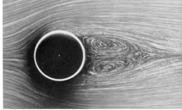
Écoulement présentant une zone turbulente
