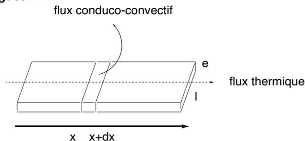
La poignée de la poêle est d'épaisseur  $e$  et de largeur  $\ell$ . Elle est traversée par un flux thermique  $\phi$  de gauche à droite (la poêle chaude est à gauche sur le schéma). Le flux conducto-convectif  $\phi_{cc}$  évacue la chaleur par les faces latérales.
